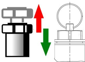
Schritt 1: Anlüfteknopf / Pull-Ring nach oben ziehen, bis ein deutliches Ausblasen des Betriebsmediums hörbar ist.
