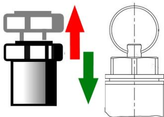
Paso 1: Tirar del botón de ventilación / anillo de tracción hacia arriba hasta que se oiga claramente como el medio de servicio es soplado hacia el exterior.
