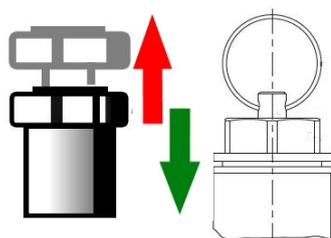
Étape 1 : Tirer le bouton de levage (pull ring) vers le haut, jusqu'à entendre clairement le fluide être propulsé vers l'extérieur.
